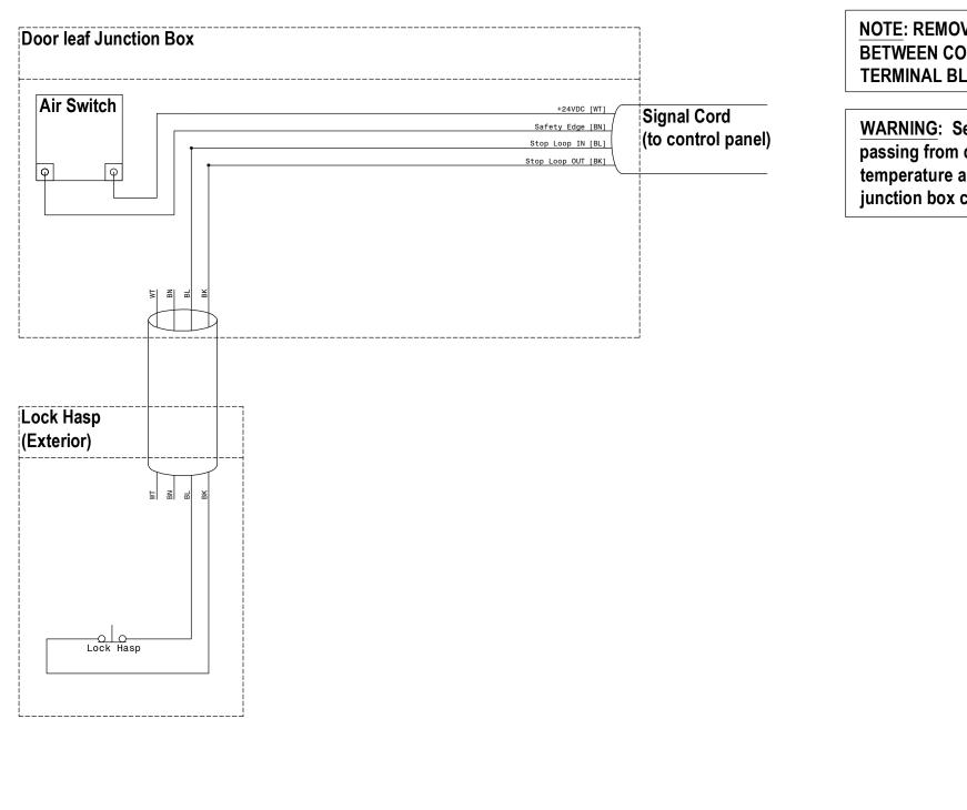
**NOTE: REMOVE JUMPER BETWEEN CONTROL PANEL TERMINAL BLOCKS 2 AND 3**
